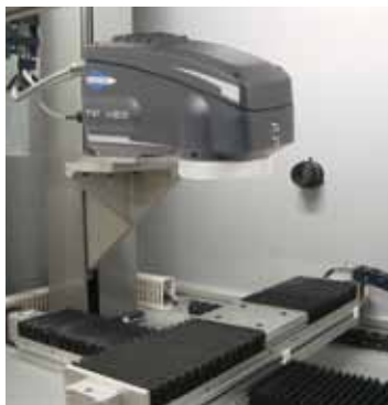
Ejemplo de integración en eje Z motorizado y mesa X/Y
